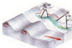
شکل ۶-۴ نحوه حرکت موج سطحی L
